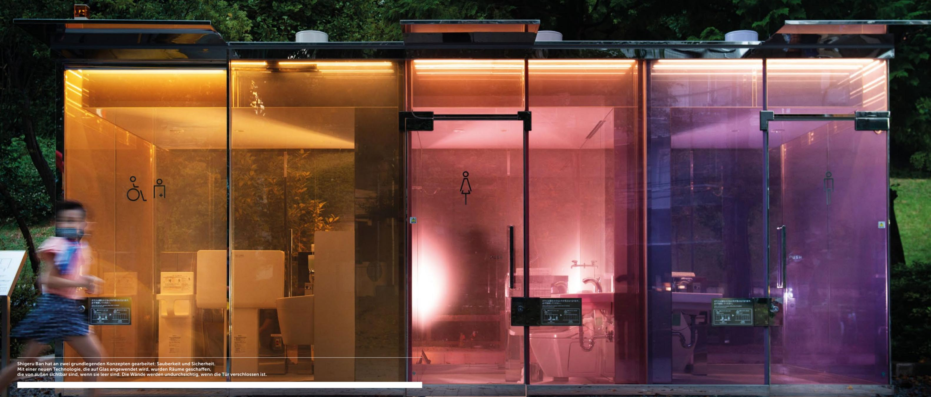
Shigeru Ban hat an zwei grundlegenden Konzepten gearbeitet: Sauberkeit und Sicherheit. Mit einer neuen Technologie, die auf Glas angewendet wird, wurden Räume geschaffen, die von außen sichtbar sind, wenn sie leer sind. Die Wände werden undurchsichtig, wenn die Tür verschlossen ist.
